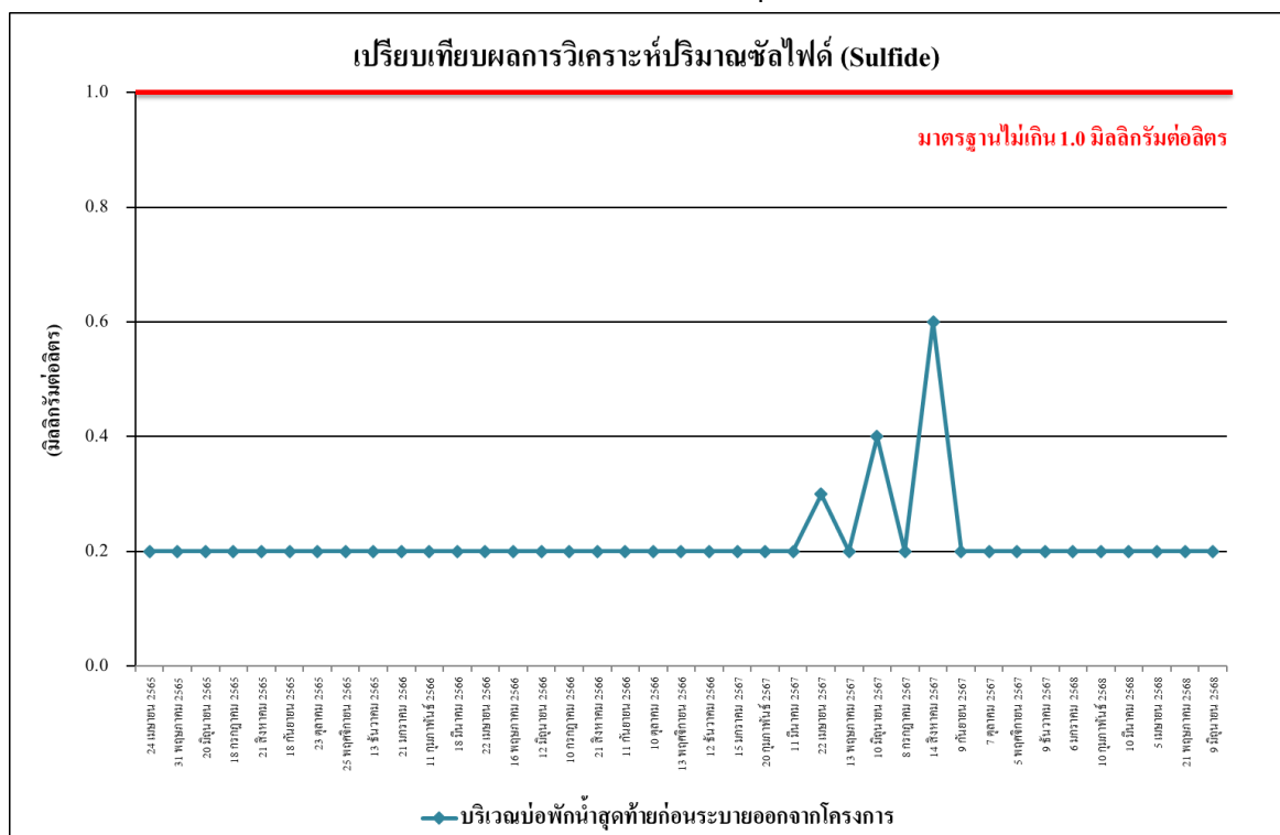
รูปที่ 4.4-55 เปรียบเทียบผลการตรวจวิเคราะห์ปริมาณของซัลไฟด์ (Sulfide)
