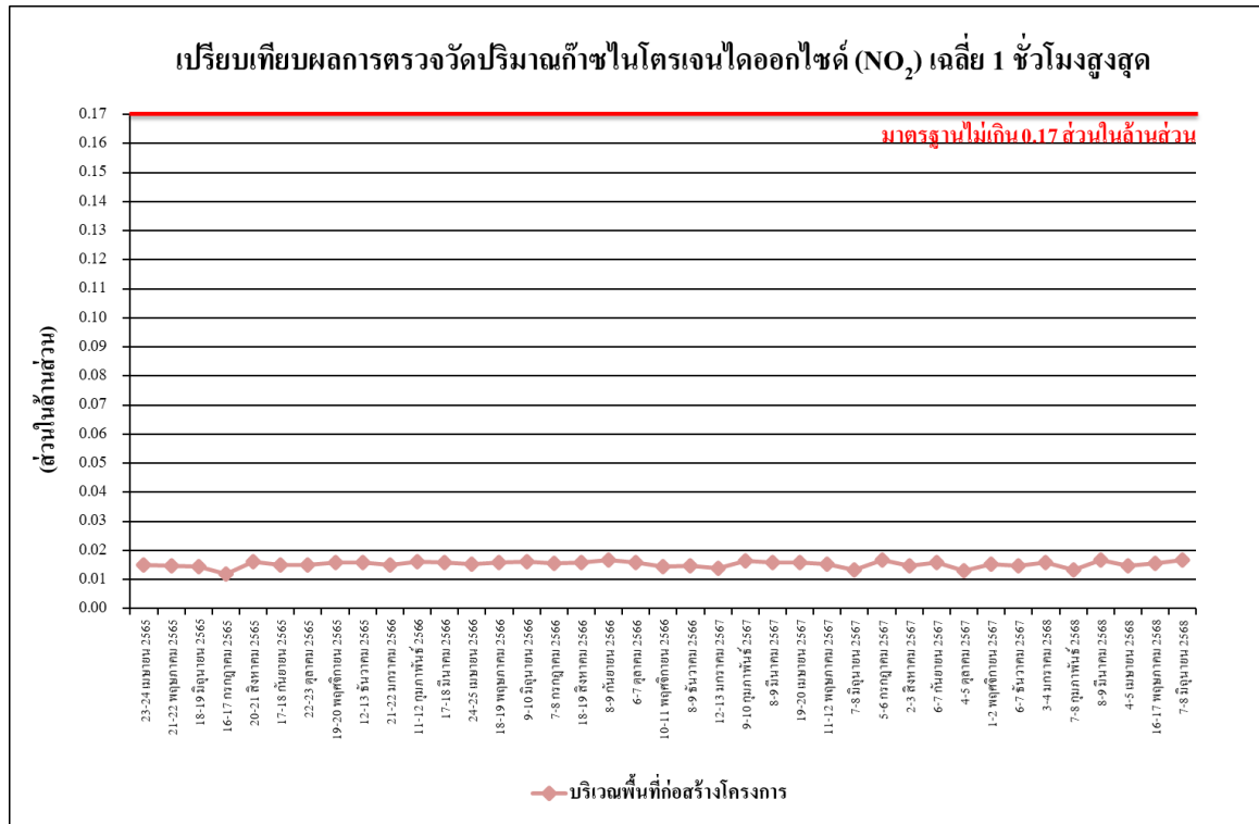
รูปที่ 4.4-21 เปรียบเทียบผลการตรวจวัดปริมาณก๊าซไนโตรเจนออกไซด์ (NO 2 ) เฉลี่ย 1 ชั่วโมงสูงสุด บริเวณพื้นที่ก่อสร้างโครงการ ระหว่างเดือนเมษายน 2565 - มิถุนายน 2568
