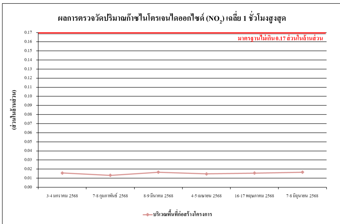
รูปที่ 4.4-7 ผลการตรวจวัดปริมาณก๊าซไนโตรเจนไดออกไซด์ (NO 2 ) เฉลี่ย 1 ชั่วโมงสูงสุด บริเวณพื้นที่ก่อสร้างโครงการ ระหว่างเดือนมกราคม-มิถุนายน 2568
